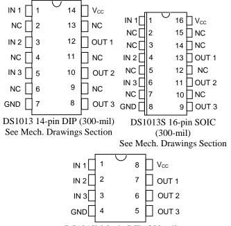
DS1013M 8-pin DIP (300-mil) See Mech. Drawings Section
